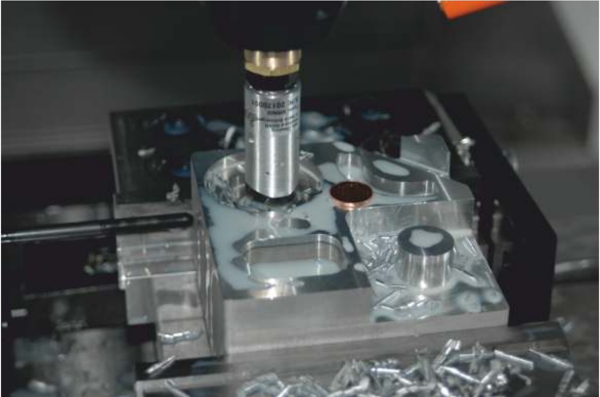
Anwendungsbeispiel: Gezieltes Abreinigen eines Werkstücks in einem CNC Bearbeitungszentrum Application example: Targeted cleaning of a workpiece in a CNC machining center
