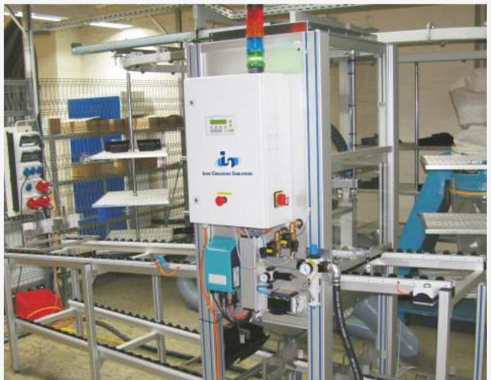
Durchlaufreinigungsanlage zur Reinigung und Entladung von beflockten Kunststoffteilen.
