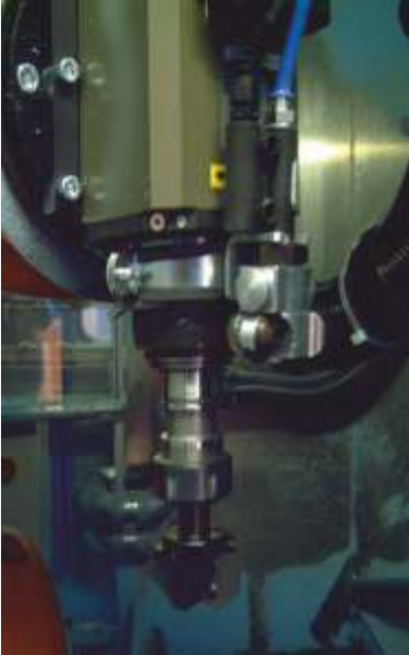
Montage direkt an der Frässpindel Mounting directly on the milling spindle
