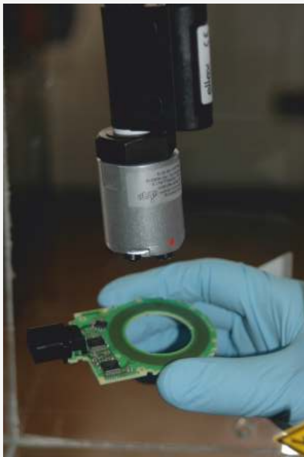
Reinigung von Leiterplatten von Hand
